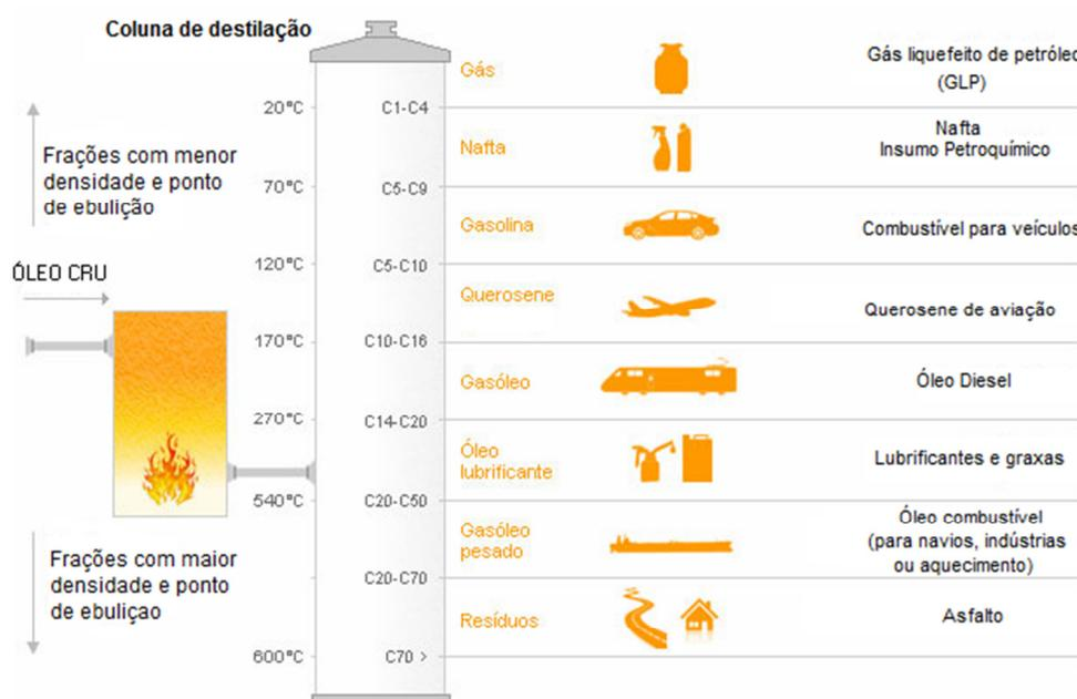
Figura 20: Principais derivados obtidos na destilação atmosférica
